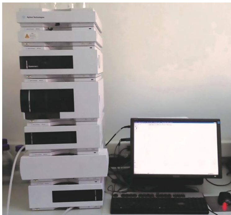
Slika 2.2. Uređaj HPLC-DAD Agilent 1200
