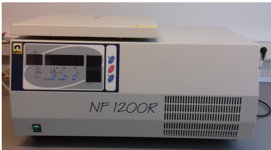
Slika 32. Centrifuga korištena za pripremu otopine sulfataze.
