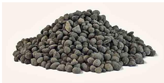
Slika 3. portland cementni klinker [4]
