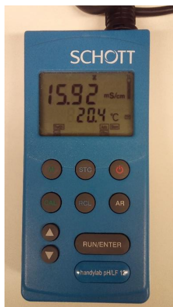
Slika 13. Uređaj za praćenje promjene provodnosti u cementnim suspenzijama.
