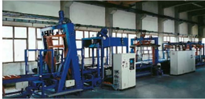
Slika 14. Stroj za rezanje stiropor blokova u ploče 14
