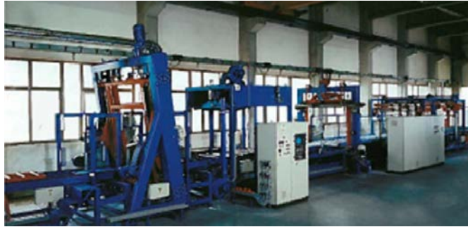
Slika 14. Stroj za rezanje stiropor blokova u ploče 14
