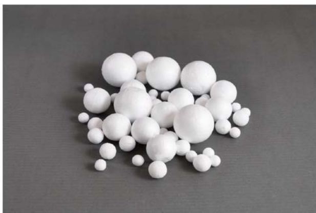
Slika 6. Kuglice pjenastog polistirena 10
