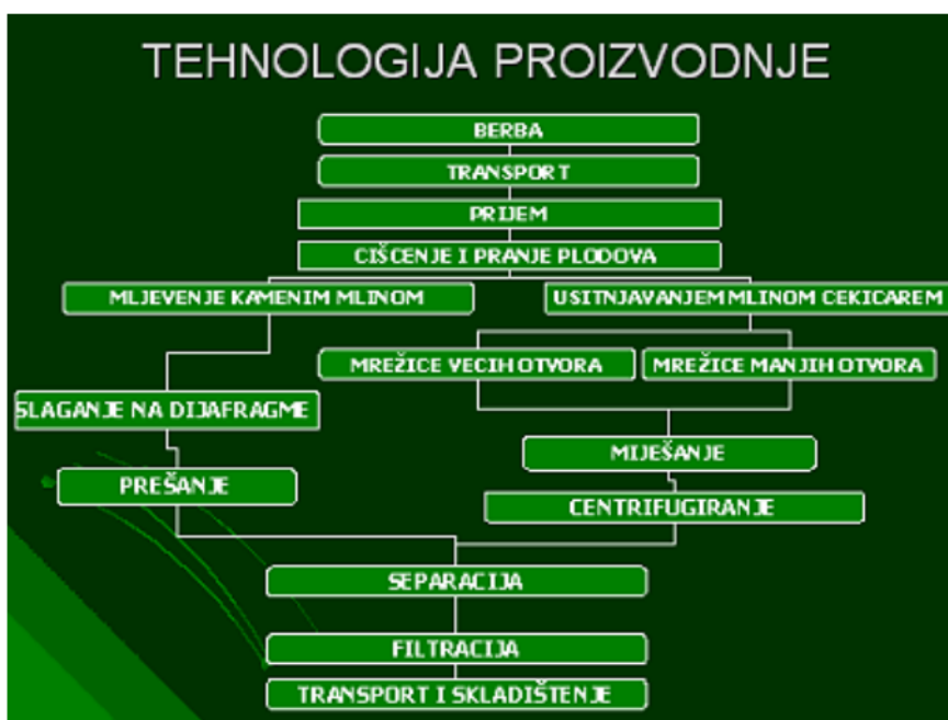
Slika 9. Tehnološki postupak proizvodnje maslinovog ulja. 26
