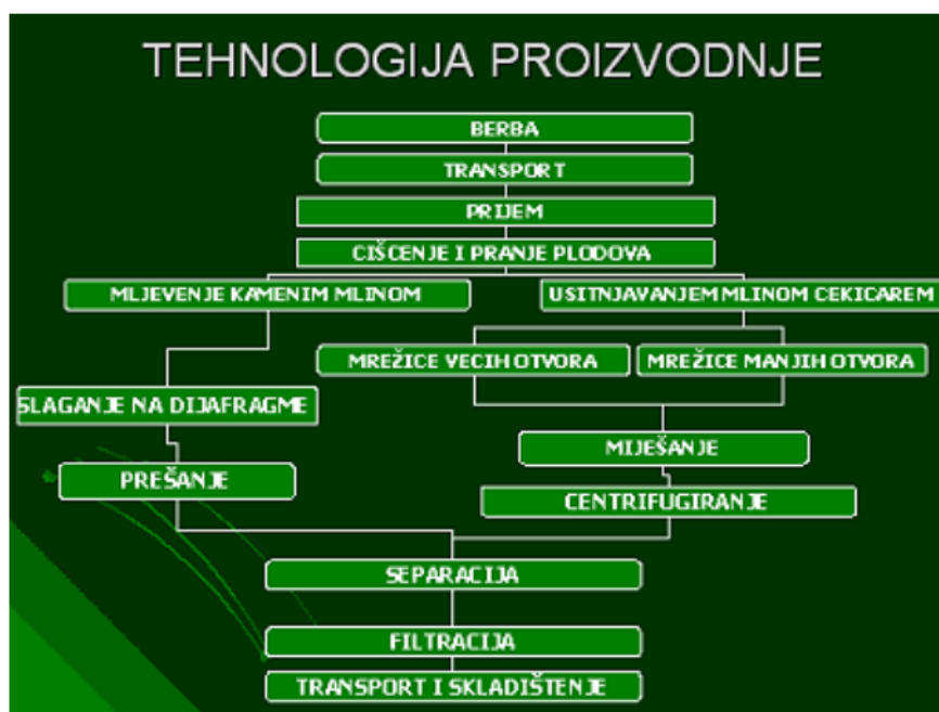
Slika 9. Tehnološki postupak proizvodnje maslinovog ulja. 26
