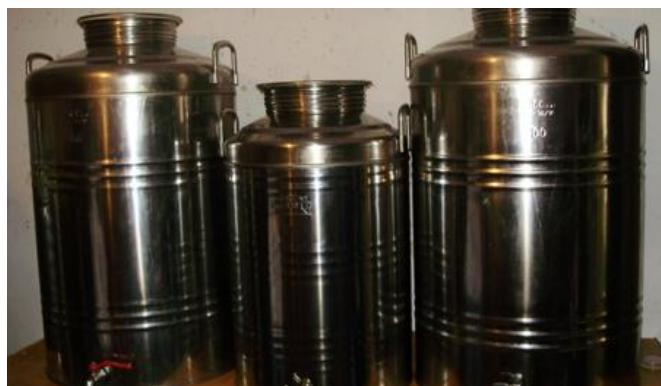
Slika 13. Spremnici od nehrnajućeg čelika za čuvanje ulja.<sup>29</sup>
