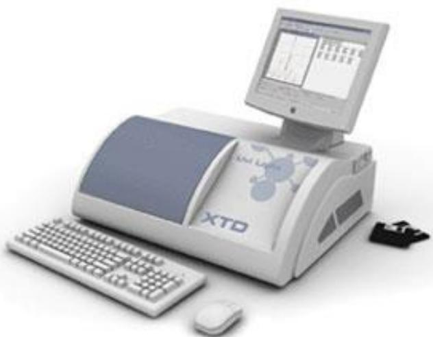
Slika 17. UV/Vis spektrofotometar(model:XTD5, proizvođač:Secomam,Frankuska).
