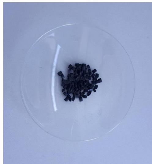
Slika 7. Uzorak 1 (polipropilen s dodatkom 20% mineralnog punila)
