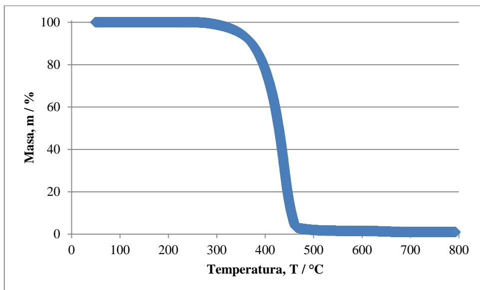
Slika 18. TG krivulja uzorka 4 (čisti polipropilen)
