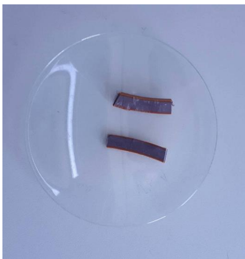
Slika 12. Uzorak 6 (PVC materijal nepoznatog sadržaja punila)
