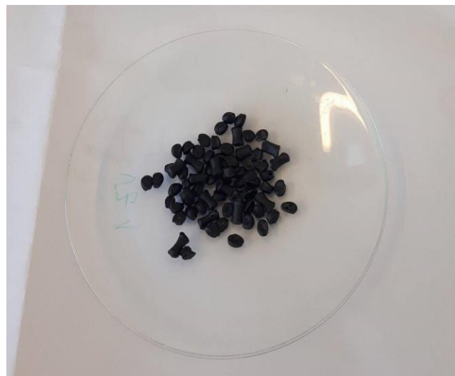
Slika 8. Uzorak 2 (polipropilen s dodatkom 30% mineralnog punila)
