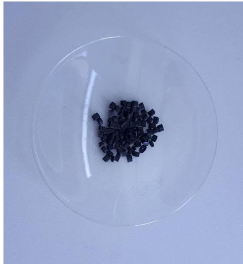
Slika 7. Uzorak 1 (polipropilen s dodatkom 20% mineralnog punila)
