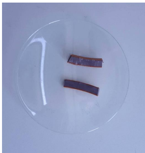
Slika 12. Uzorak 6 (PVC materijal nepoznatog sadržaja punila)
