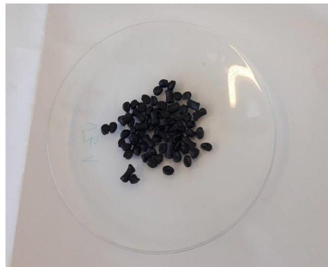
Slika 8. Uzorak 2 (polipropilen s dodatkom 30% mineralnog punila)
