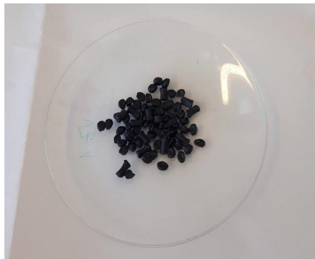
Slika 8. Uzorak 2 (polipropilen s dodatkom 30% mineralnog punila)
