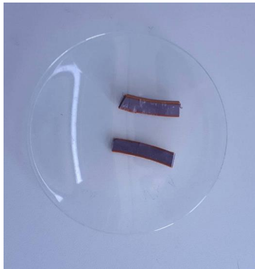
Slika 12. Uzorak 6 (PVC materijal nepoznatog sadržaja punila)
