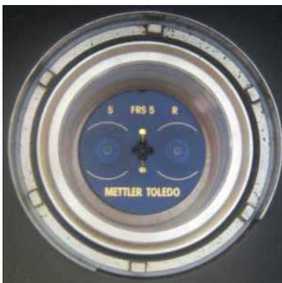
Slika 22. Mjerno osjetilo (FRS 5) DSC uređaja
