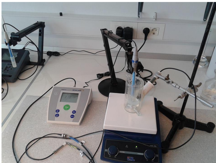
Slika 23. Elektrokemijska ćelija sa elektrodama za mjerenje potencijala
