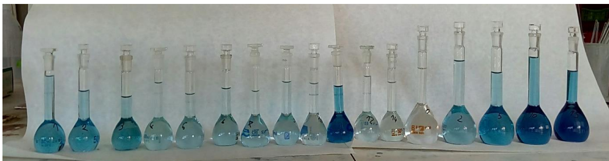
Slika 14. Modro obojenje uzoraka i standarda pripremljenih metodom po Trougu
