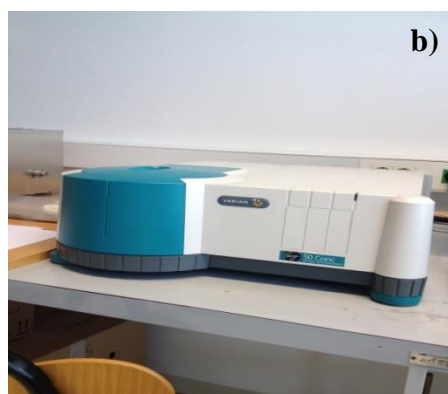
Slika 6. a) Pripremljeni uzorci b) Aparatura za spektrofotometrijsko određivanje sadržaja amonijačnog dušika u tlu
