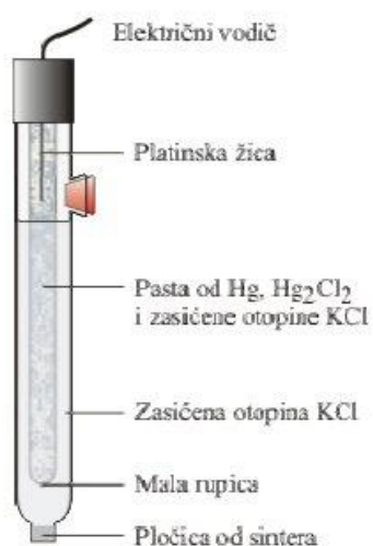
Slika 3. Shematski prikaz zasićene kalomel elektrode 3
