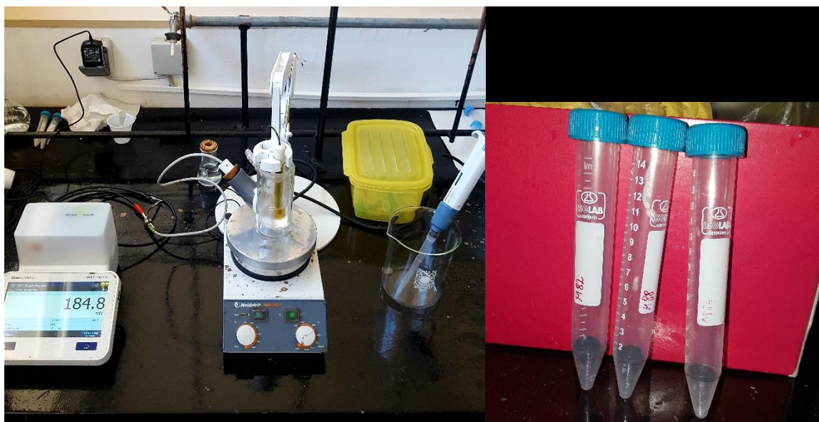
Slika 12. Prikaz pripremljenih ionsko selektivnih elektroda i sustava za potenciometrijsko mjerenje.
