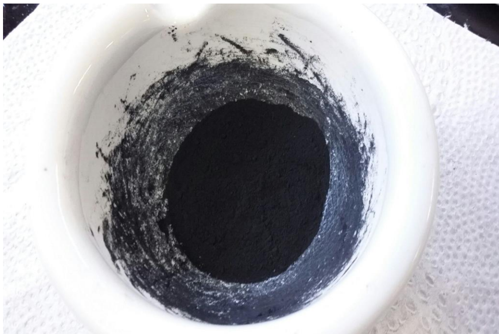
Slika 11. Izgled usitnjenog srebrovog sulfida u tarioniku
