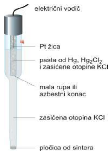
Slika 5. Prikaz kalomelove elektrode 3
