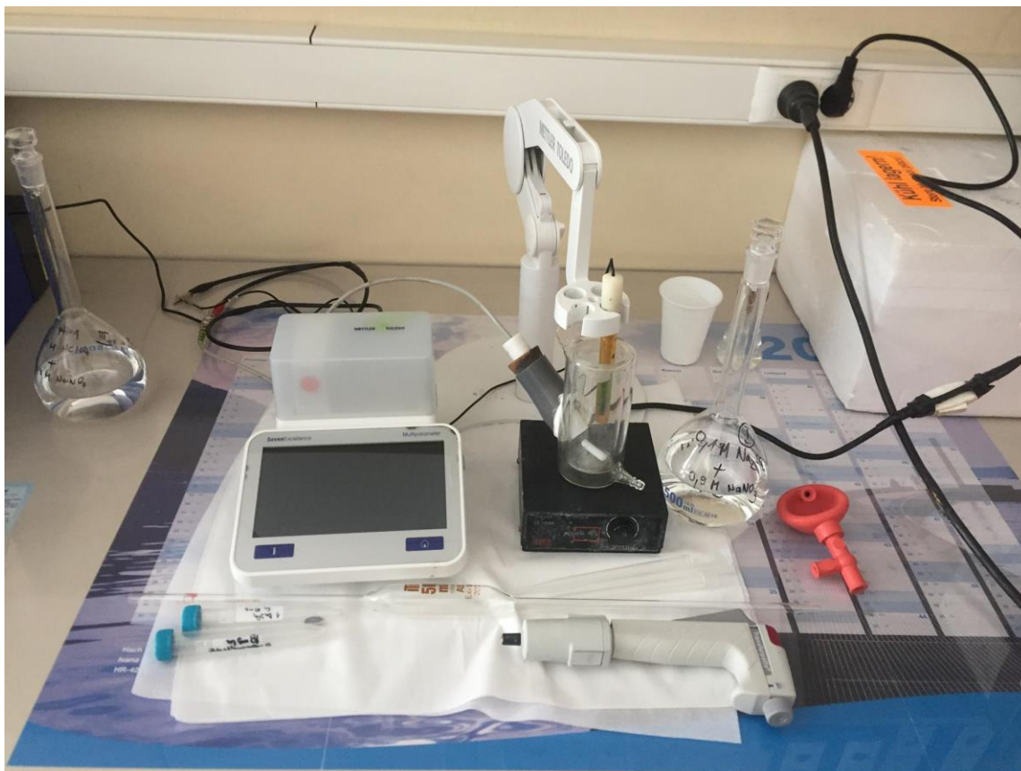
Slika 7. Aparatura za potenciometrijsko mjerenje
