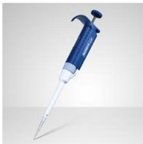
Slika 3-4 Mikropipeta s ručnim držačem<sup>[21]</sup>
