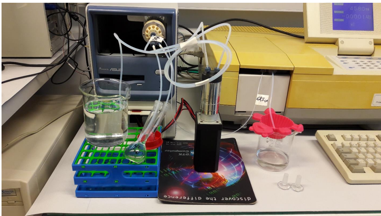
Slika 3-10 Izvedba sustava za slijednu analizu injektiranjem
