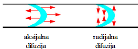
Slika 3.4. Prikaz aksijalne difuzije, koja uzrokuje laminarno gibanje, i radijalne difuzije, koja uzrokuje turbulentno gibanje
