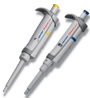
Slika 3.9. Mikropipete Eppendorf s ručnim držačem za dodavanje volumena od 10 do 100 \mu\text{L} (žuta) i 100 do 1000 \mu\text{L} (plava)
