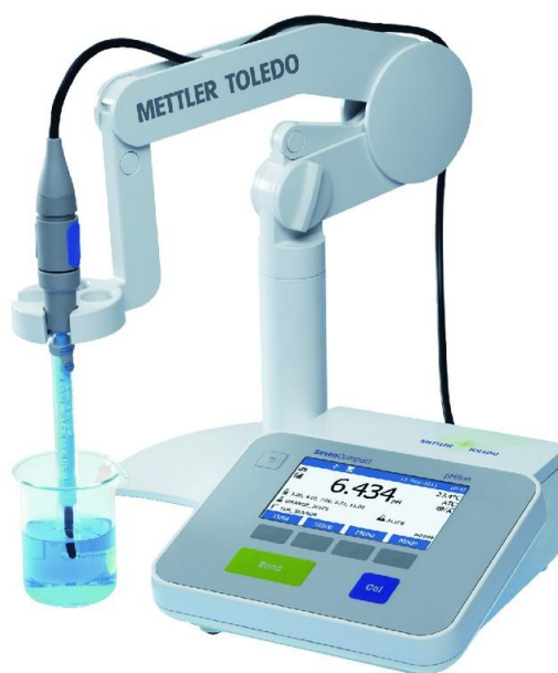
Slika 3.5. Milivoltmetar korišten za mjerenje pH vrijednosti [20]
