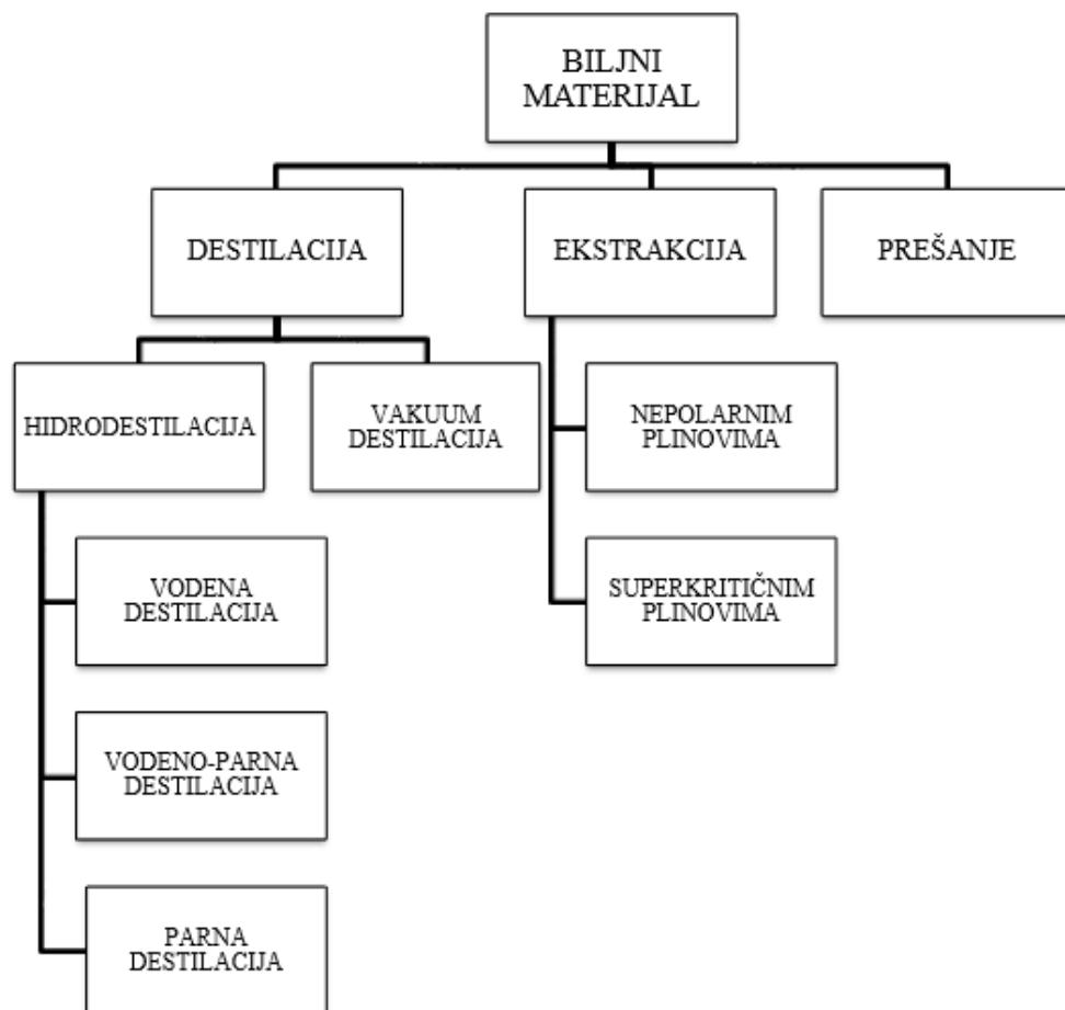
Slika 1.10. Shematski prikaz metoda izolacije hlapljivih sastojaka
