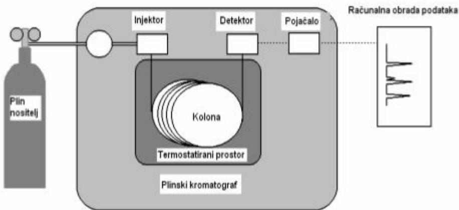
**Slika 1.12.** Shematski prikaz plinskog kromatografa
