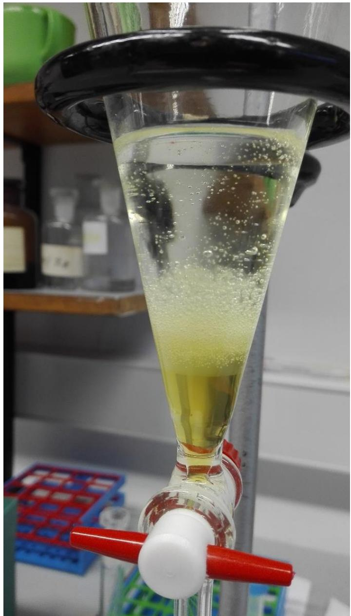
**Slika 2.2.** Odijeljeni slojevi u lijevkusu za odijeljivanje
