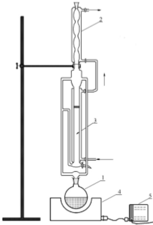
**Slika 1.11.** Shematski prikaz aparature po Clevengeru
