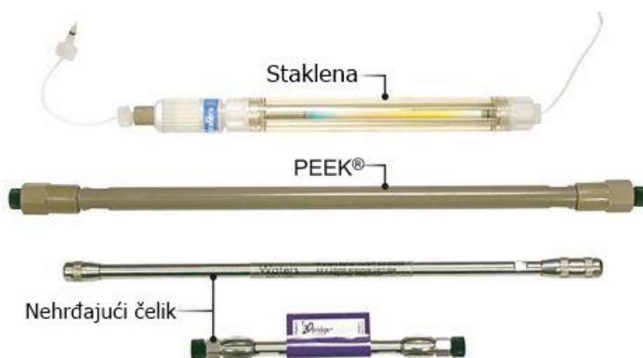
Slika 9. Tri vrste kolona za HPLC.[30]
