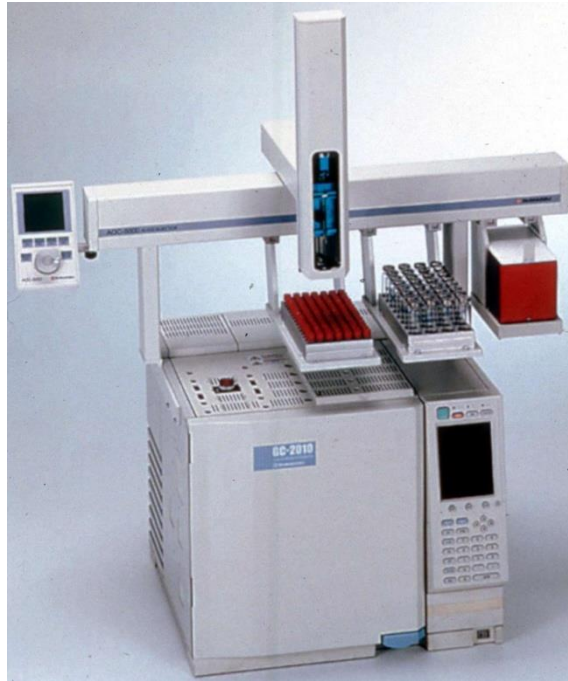
Slika 5. Plinski kromatograf s plameno-ionizacijskim detektorom; Shimadzu GC-2010 (46).
