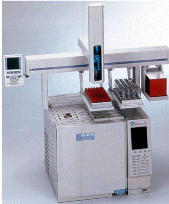
Slika 5. Plinski kromatograf s plameno-ionizacijskim detektorom; Shimadzu GC-2010 (46).
