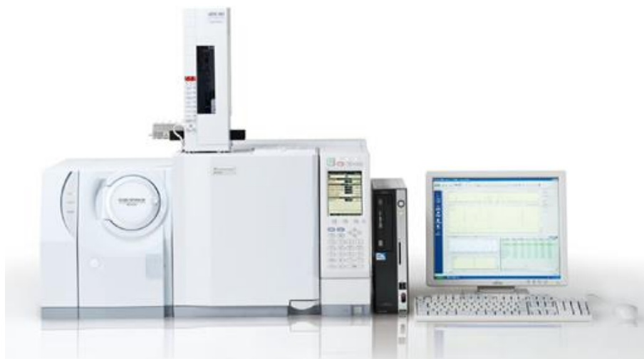
Slika 5. Plinski kromatograf sa spektrometrom masa, Shimadzu GCMS-QP2010 (44)
