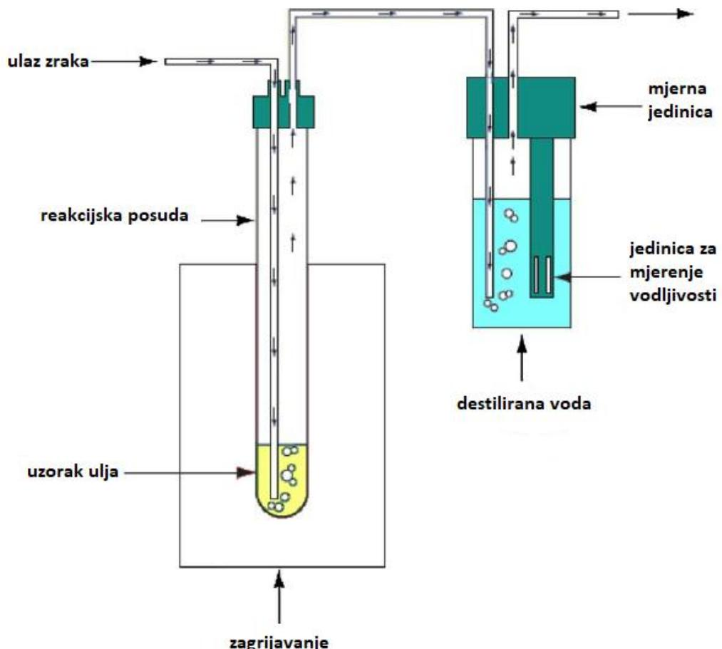
Slika 8. Shema određivanja oksidacijske stabilnosti korištenjem uređaja Rancimat [23].
