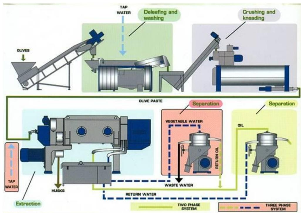
*Slika 1.* Shema suvremenog postrojenja za proizvodnju maslinovog ulja<sup>15</sup>
