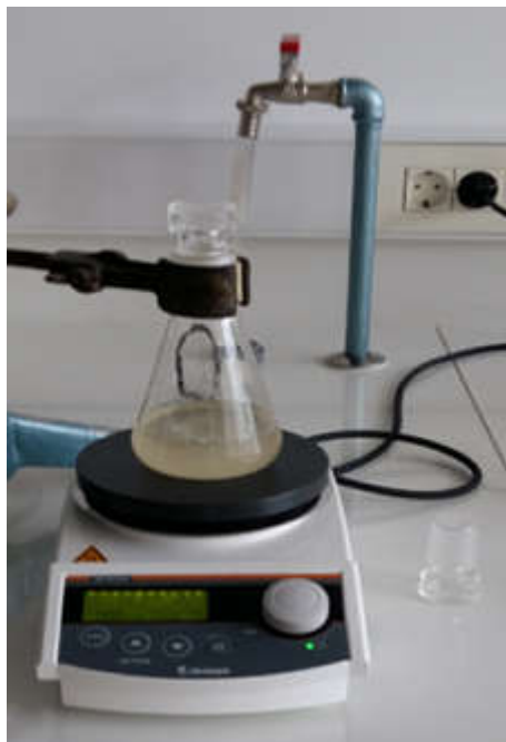
Slika 13. Aparatura za ekstrakciju tekuće-tekuće
