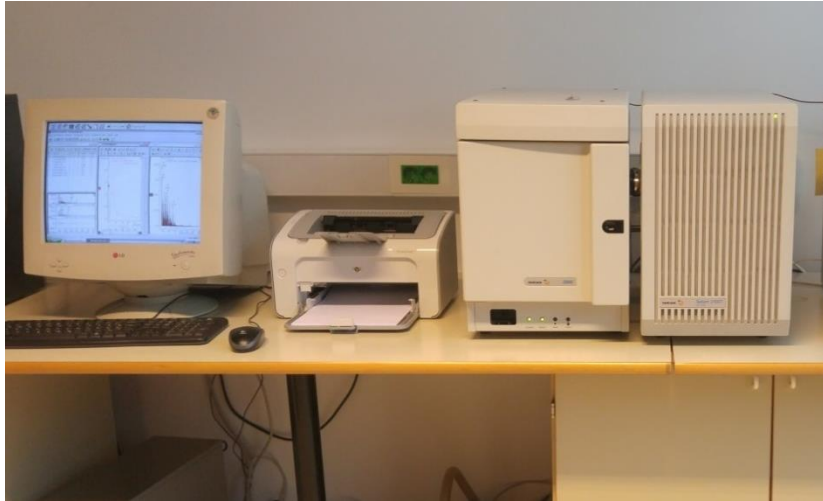
Slika 11. Vezani sustav plinske kromatografije – spektrometrije masa
