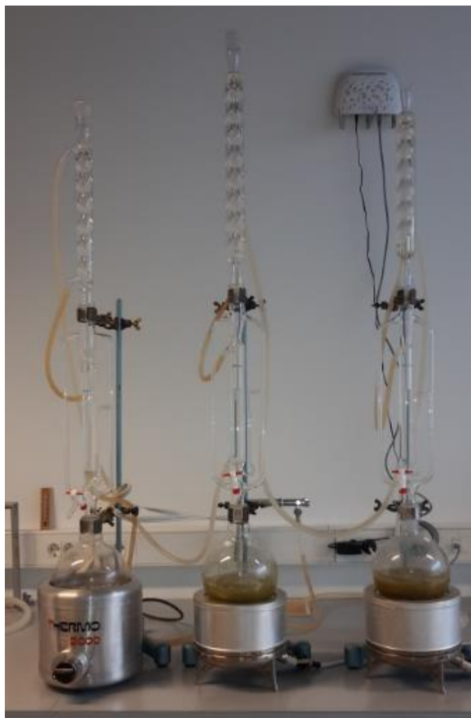
Slika 10. Destilacija u aparaturi po Clevengeru
