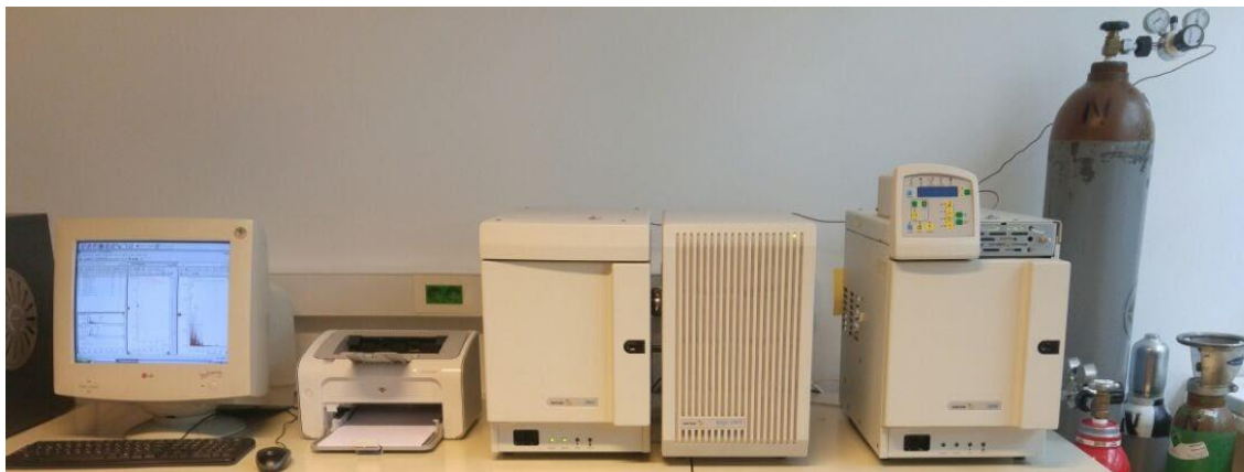
Slika 2.11. Vezani sustav plinska kromatografija-spektrometrija masa (GC-MS)
