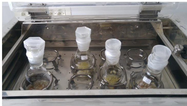
Slika 2.7. Autoliza u vodenoj kupelji
