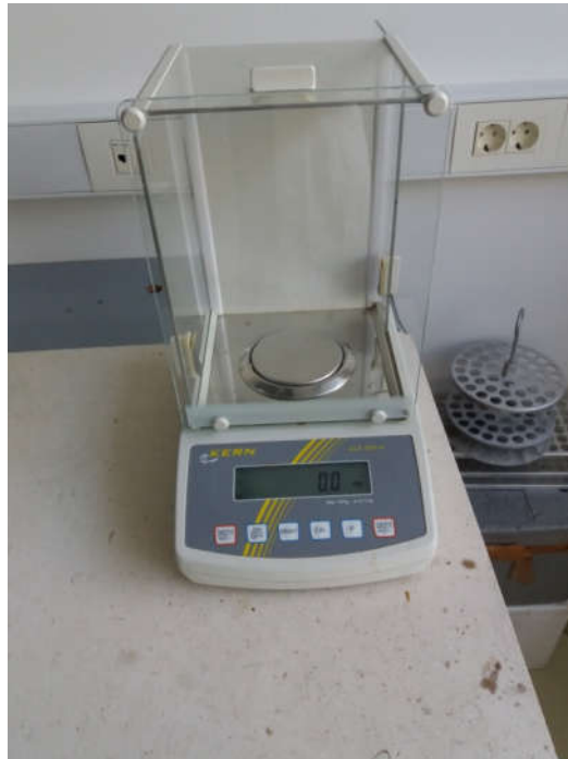
Slika 8. Digitalna vaga (Kern ALS 120-4).
