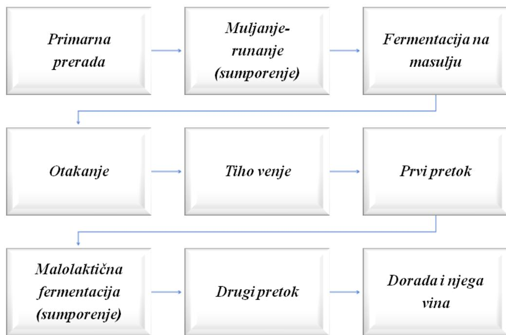
*Slika 4.* Tehnološka shema proizvodnje crnog vina.
