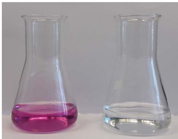
Slika 2.3. Prijelaz boje u točki ekvivalencije pri kompleksometrijskoj titraciji cinka uz indikator 3,3-dimetilnaftidin.
