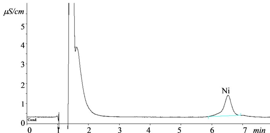
Slika 2.2. Primjer kromatograma određivanja nikla
