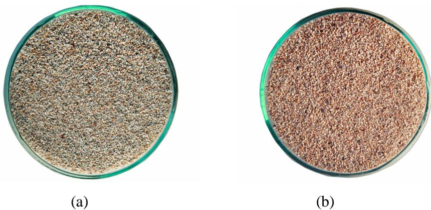
Slika 2.1. Usporedba prirodnog (a) i Fe(III)-modificiranog zeolita (b)
