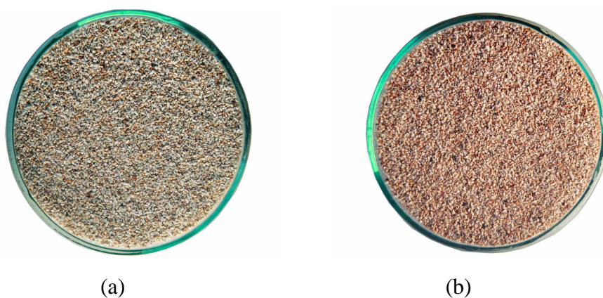
Slika 2.1. Usporedba prirodnog (a) i Fe(III)-modificiranog zeolita (b)
