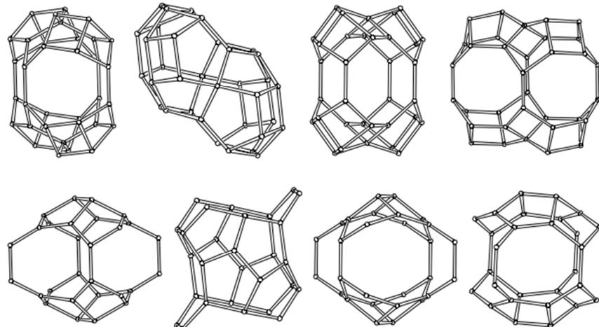
Slika 1.10. Tercijarne građevne jedinice zeolita<sup>33</sup>
