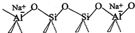
Slika 1.8. Shematski prikaz povezivanja primarnih strukturnih jedinica  $[\text{SiO}_4]^{4-}$  i  $[\text{AlO}_4]^{5-}$  tetraedara<sup>29</sup>
