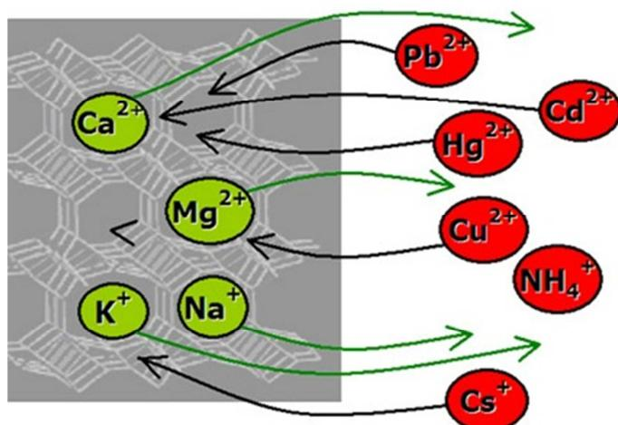
Slika 1.11. Ionska izmjena strukturalnih zeolitnih kationa s ionima teških metala<sup>35</sup>
