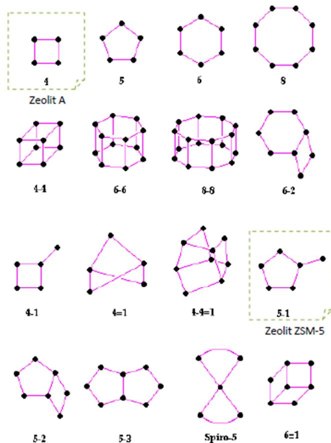
Slika 1.9. Sekundarne građevne jedinice zeolita<sup>32</sup>
