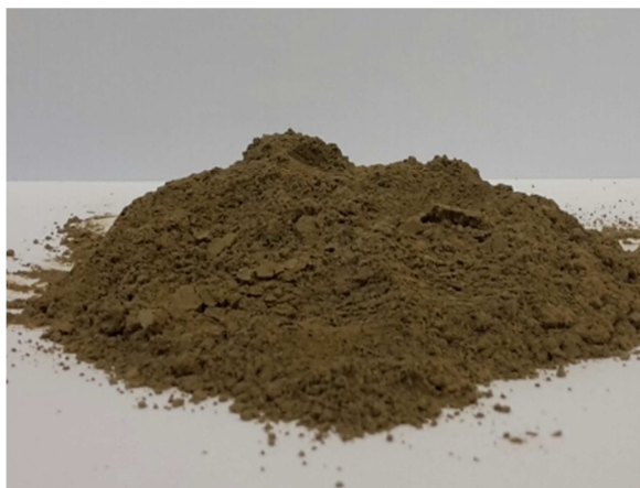
Slika 2.2. Pripremljeni uzorak tlaveličine čestica 0,075 mm
