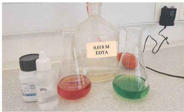
**Slika 5.** Određivanje ukupne tvrdoće titracijom uzorka izvorske vode s otopinom 0,018 M EDTA uz koncentrirani amonijak i pufer tebletu do prijelaza boje iz crvenkaste u zelenu
