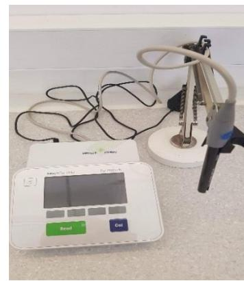
*Slika 3.* Konduktometar s elektrodom
