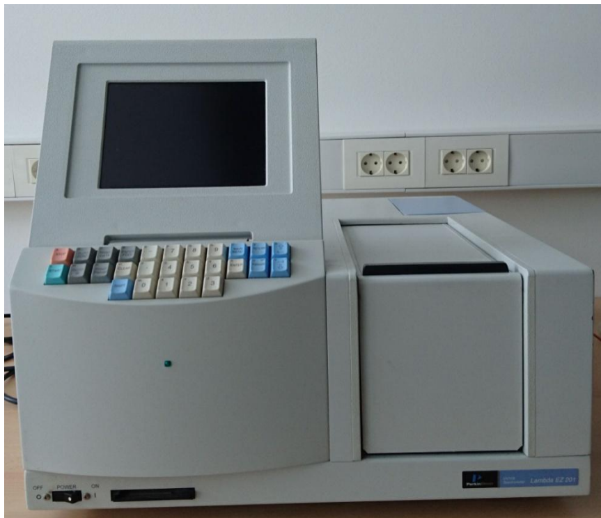
Slika 2.4 Spektrofotometar Perkin Elmer Lambda EZ 201
