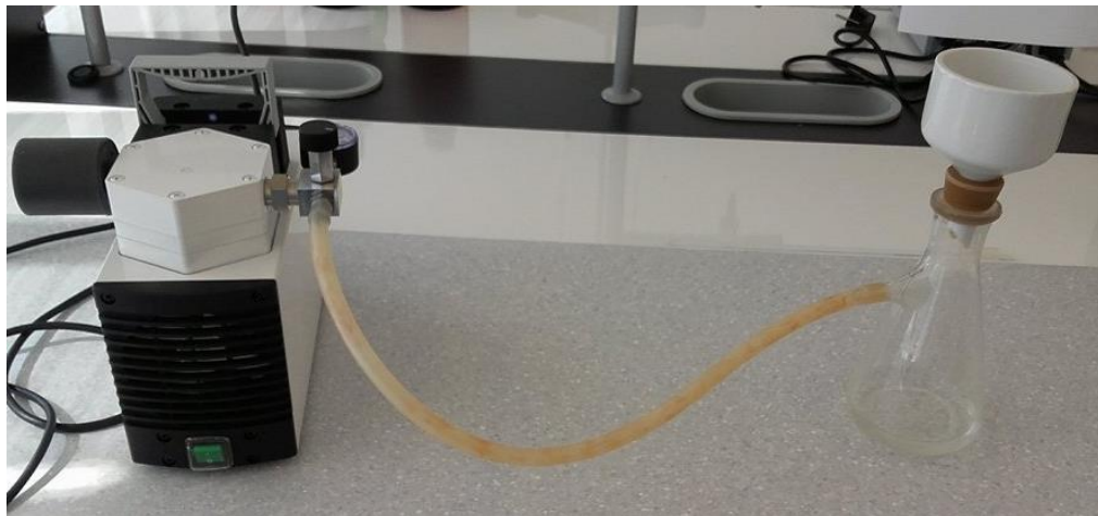
Slika 8. Aparatura za filtraciju kroz Büchnerov lijevak
