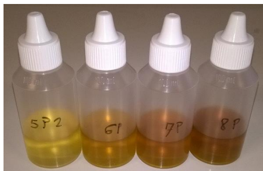
Slika 10. Otopine koloidnog srebra pripremljene demineraliziranom vodom s pH = 6,08 poredanih s lijeva na desno počevši s najnižom koncentracijom.
