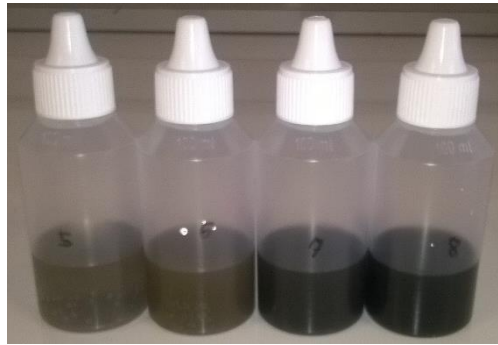
Slika 8. Otopine koloidnog srebra pripremljene destiliranom vodom poredanih s lijeva na desno počevši s najnižom koncentracijom.
