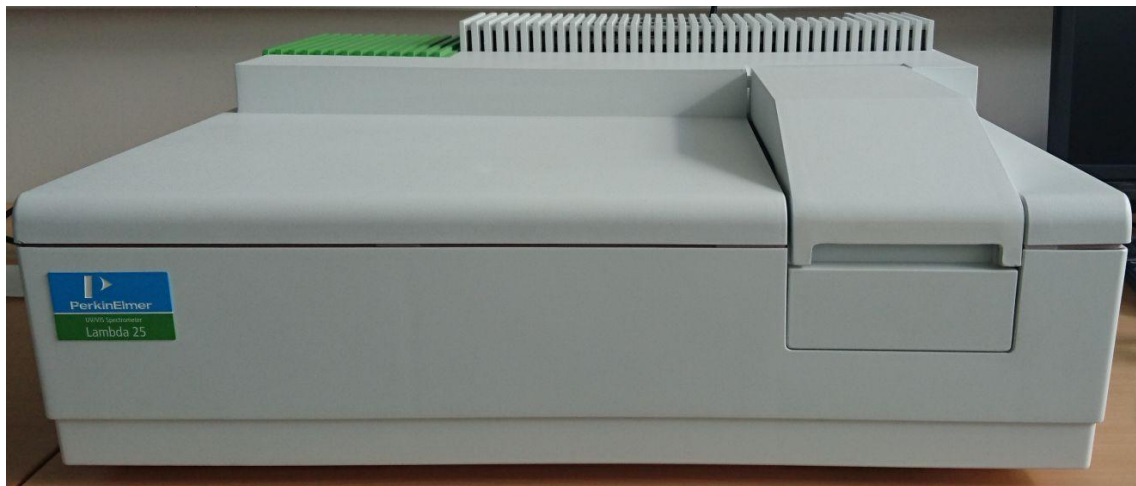
Slika 2.4 Spektrofotometar Perkin Elmer Lambda 25.
