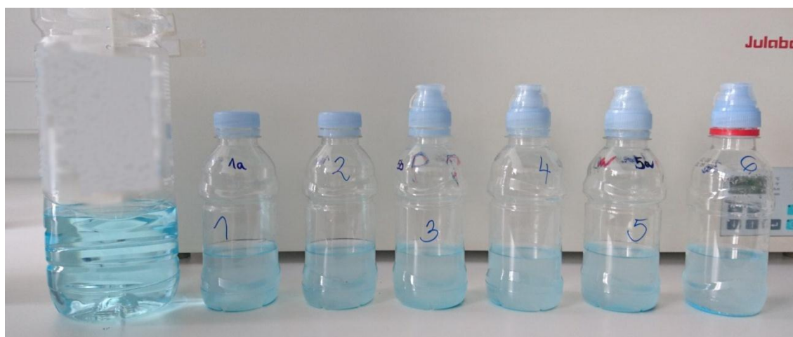
Slika 3.3 Usporedba boja početne vodene otopine \text{CuSO}_4 \cdot 5\text{H}_2\text{O} s uzorcima zeolita A (1-6) u vodenoj otopini \text{CuSO}_4 \cdot 5\text{H}_2\text{O} nakon sorpcije bakrovih iona
