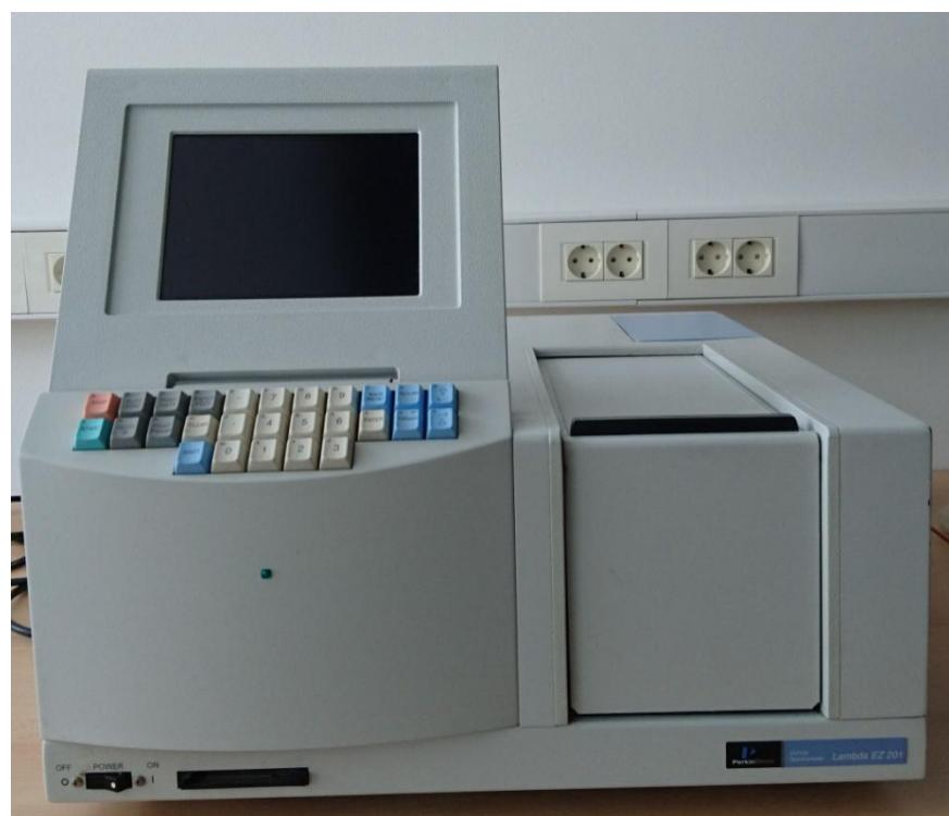
*Slika 2.4 Spektrofotometar Perkin Elmer Lambda EZ 20*
