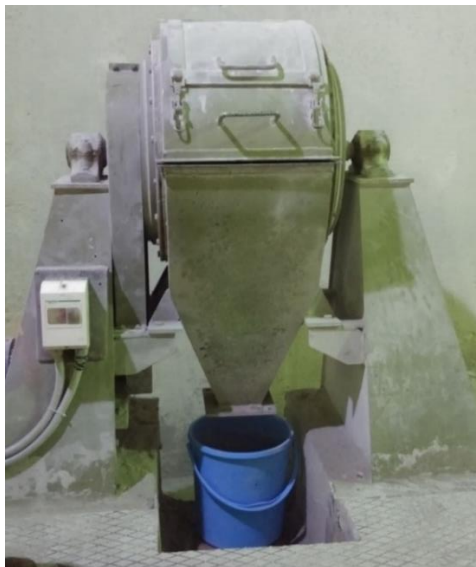
Slika 6. Prikaz poluindustrijskog horizontalnog mlina s čeličnim kuglama [14]
