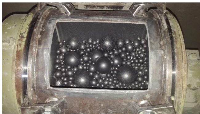
Slika 7. Punjenje poluindustrijskog horizontalnog mlina s čeličnim kuglama [14]
