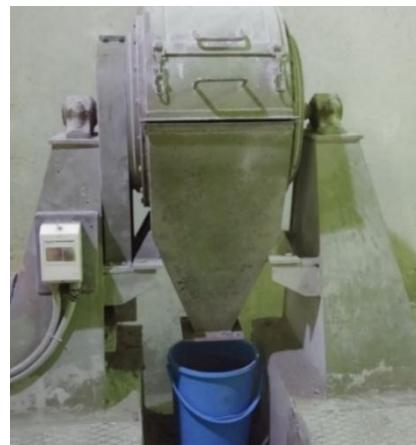
Slika 3. Prikaz poluindustrijskog horizontalnog mlina s čeličnim kuglama [11]
