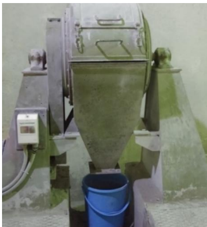
Slika 3. Prikaz poluindustrijskog horizontalnog mlina s čeličnim kuglama [11]
