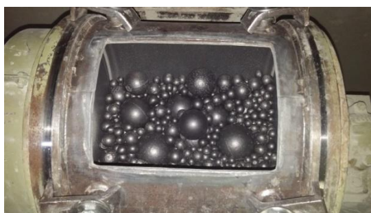
Slika 4. Punjenje poluindustrijskog horizontalnog mlina s čeličnim kuglama [11]
