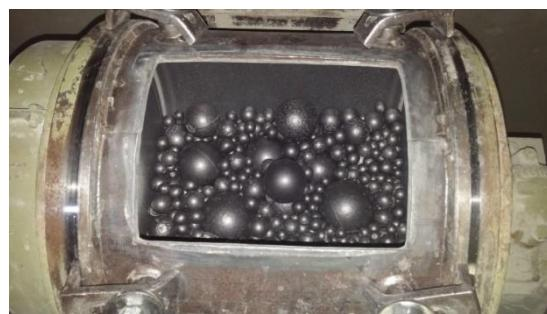
Slika 4. Punjenje poluindustrijskog horizontalnog mlina s čeličnim kuglama [11]
