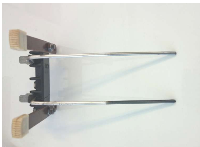
Slika 5. Elektrode nakon provedenog eksperimenta; vidljiv je tamni talog.
