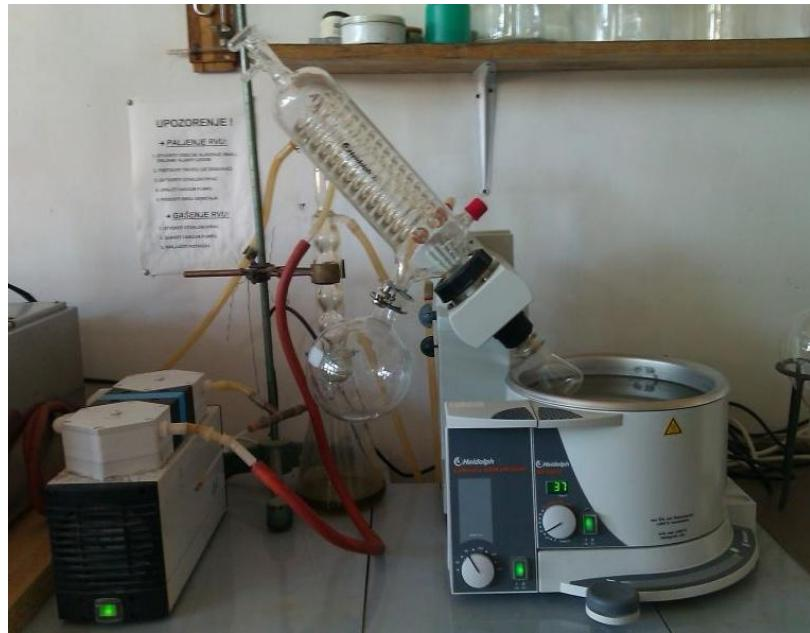
Slika 2.3 Rotacijski vakuum uparivač
