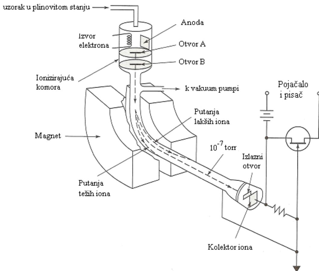
Slika 1.7 Shematski prikaz rada spektrometra masa<sup>6</sup>
