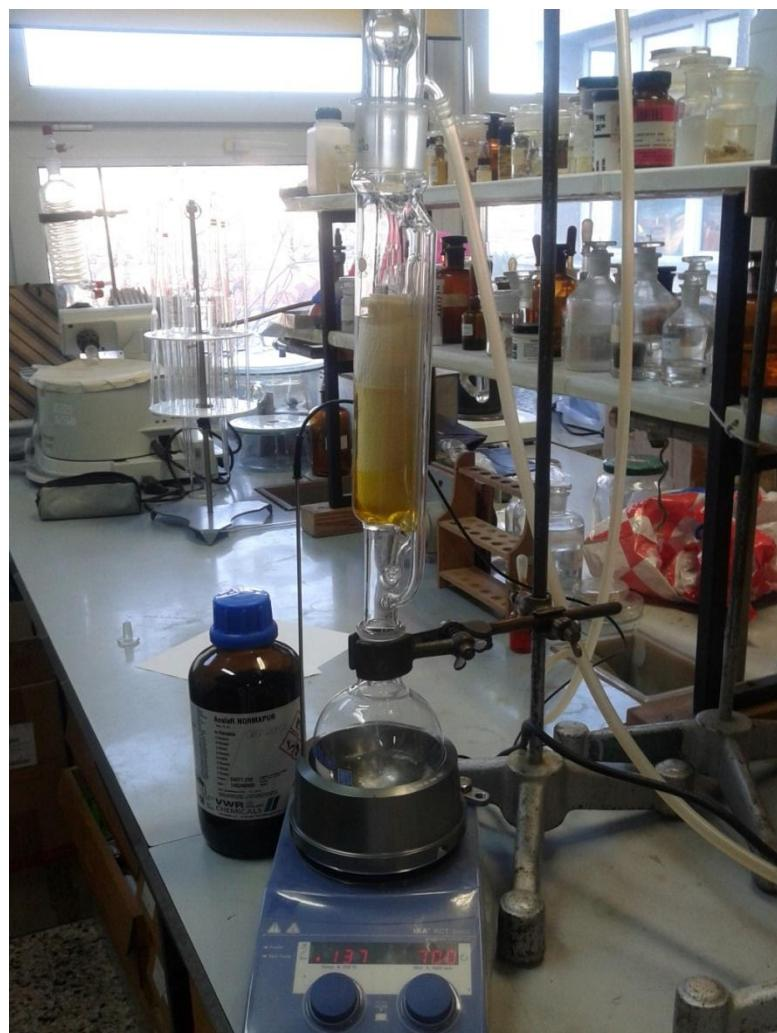
Slika 2.2 Aparatura po Soxhletu
