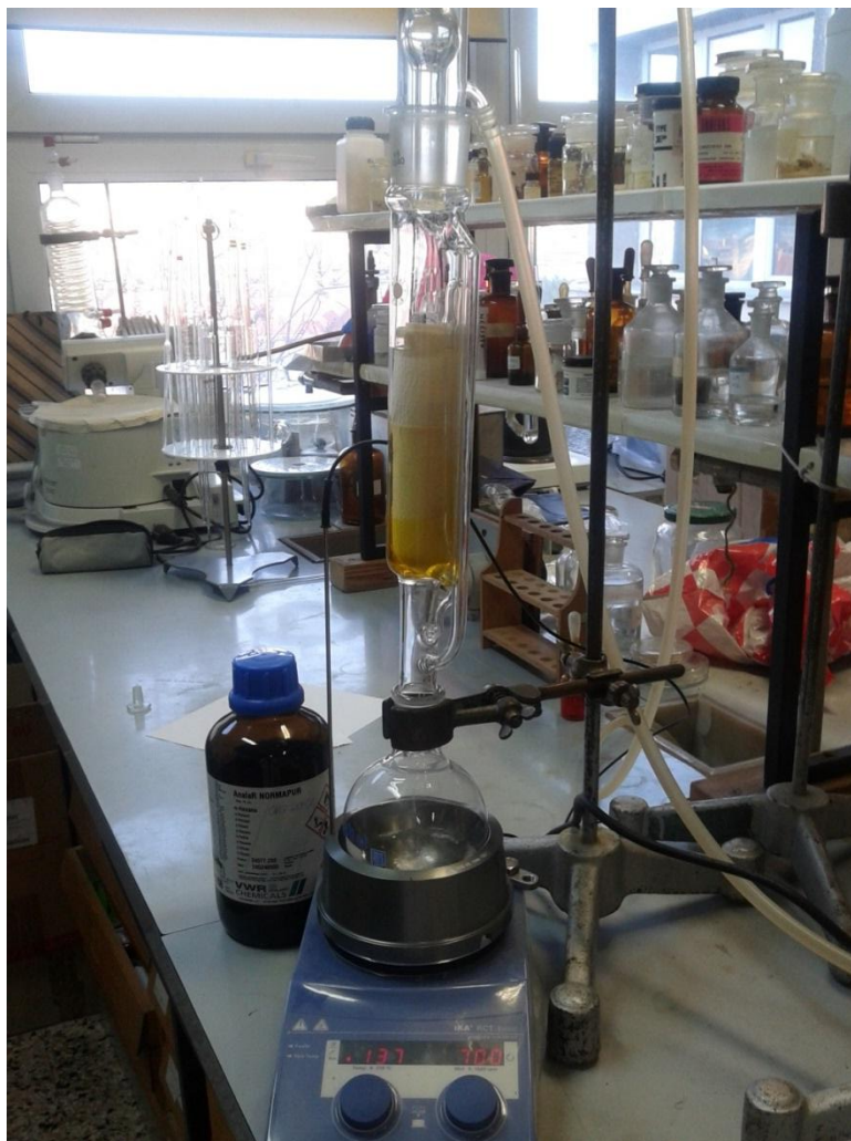
Slika 2.2 Aparatura po Soxhletu
