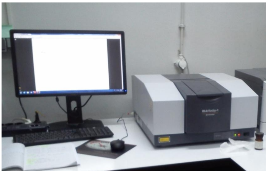
Slika 2.6 IRAffinity-1 FTIR spektrometar
