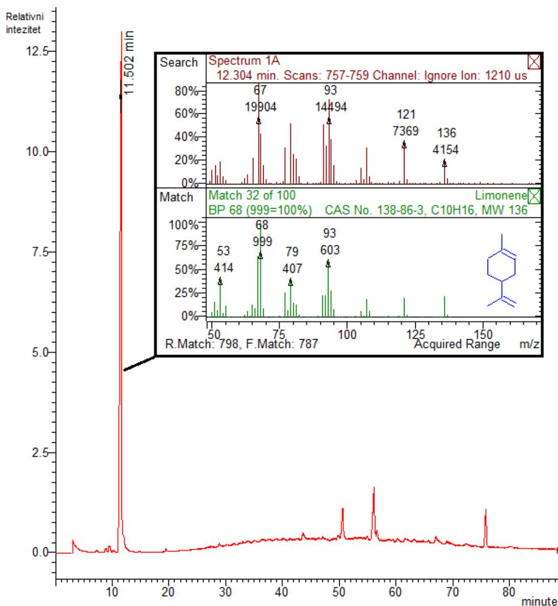
Slika 3.1 Kromatogram ukupne ionske struje heksanskog ekstrakta grejpa i spektar masa limonena usporedjen s masenim spektrom iz baze spektara masa po Wiley-u
