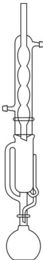
Slika 1.4 Soxhlet aparatura za ekstrakciju<sup>5</sup>
