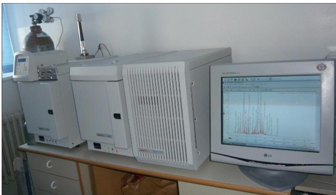
Slika 2.4 Vezani sustav plinska kromatografija – spektrometrija masa (GC-MS)
