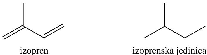
Slika 1.1 Izopren i izoprenska jedinica
