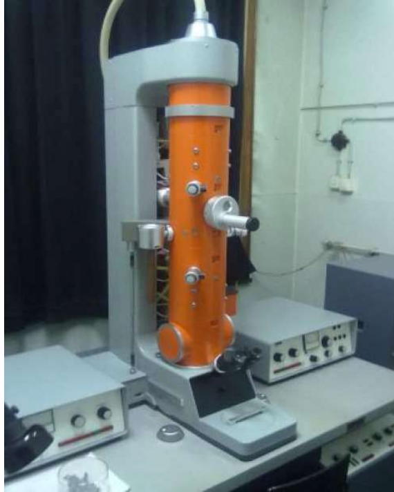
Slika 14. Transmisijski elektronski mikroskop (TEM), model Zeiss EM10.
