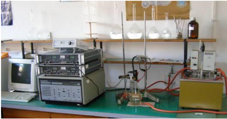
Slika 6. Aparatura za provedbu elektrokemijskih mjerenja
