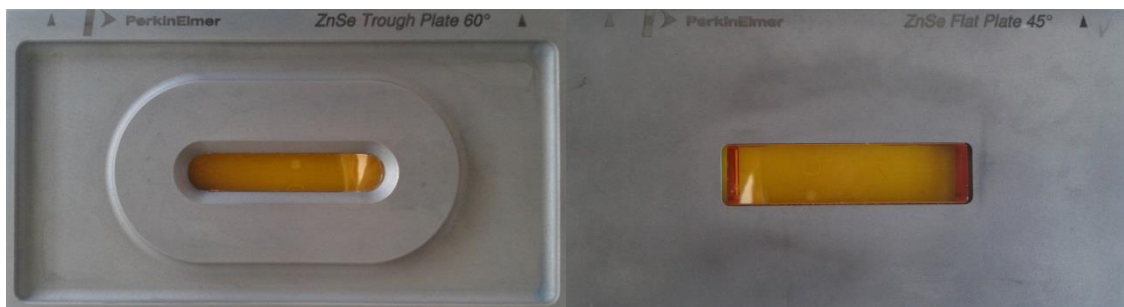
Slika 7. ZnSe kristal za kapljevite i praškaste uzorke
