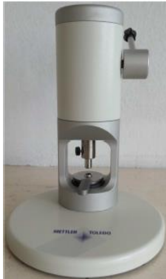
Slika 18. Preša za DSC (Mettler Toledo)
