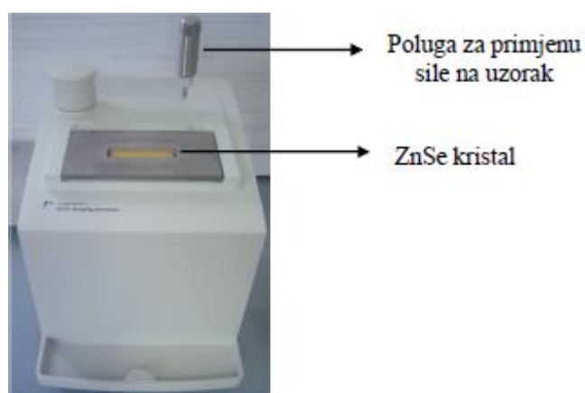
Slika 20. Dodatak za snimanje uzorka HATR tehnikom
