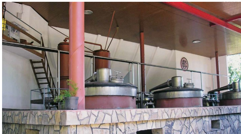
Slika 4. “Moderno,, vrijeme - vodeno-parna destilacija ružinog ulja na “veliko“ 1
