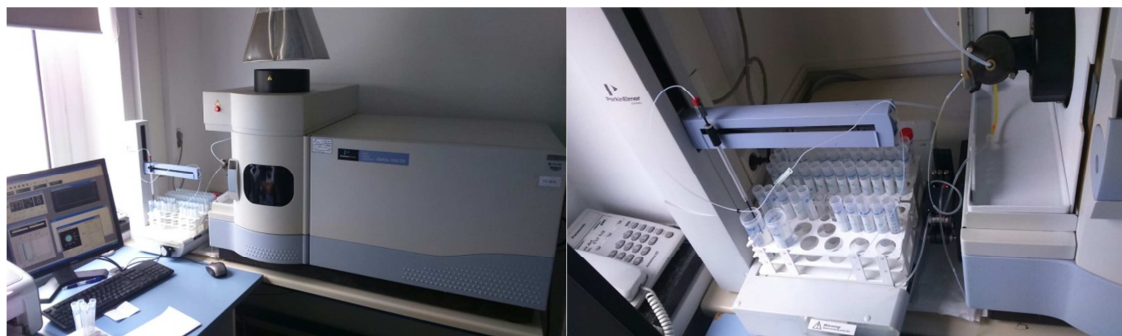
Slika 14. Određivanje sadržaja metala ICP-OES metodom
