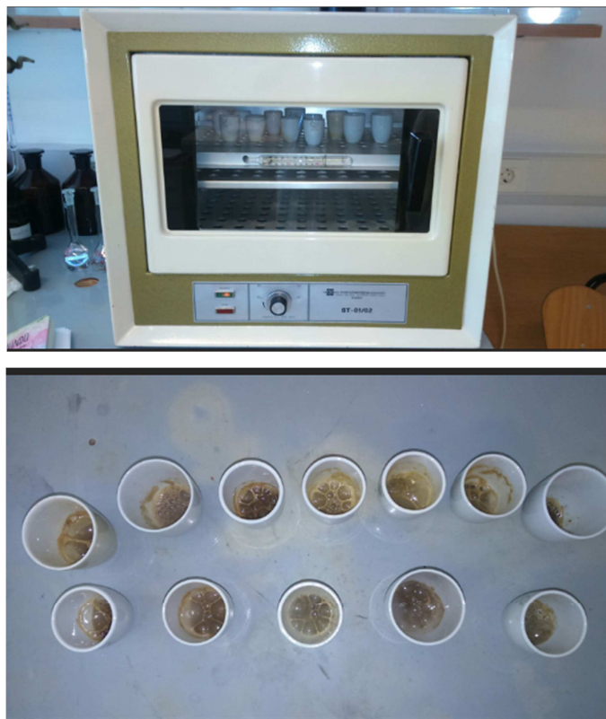
Slika 12. Određivanje organske tvari u sedimentu gravimetrijskom metodom
