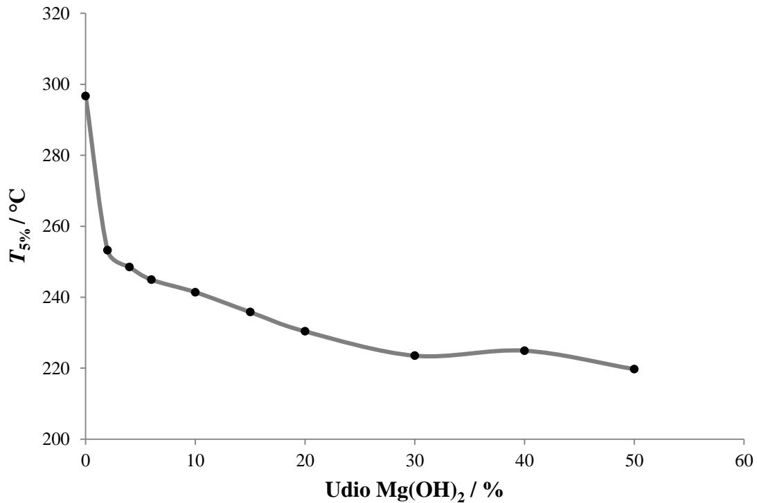
**Slika 34.** Ovisnost  $T_{5\%}$  o udjelu  $\text{Mg(OH)}_2$  u PLA kompozitu
