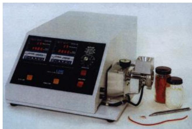
**Slika 8.** Jednopužni laboratorijski ekstruder
