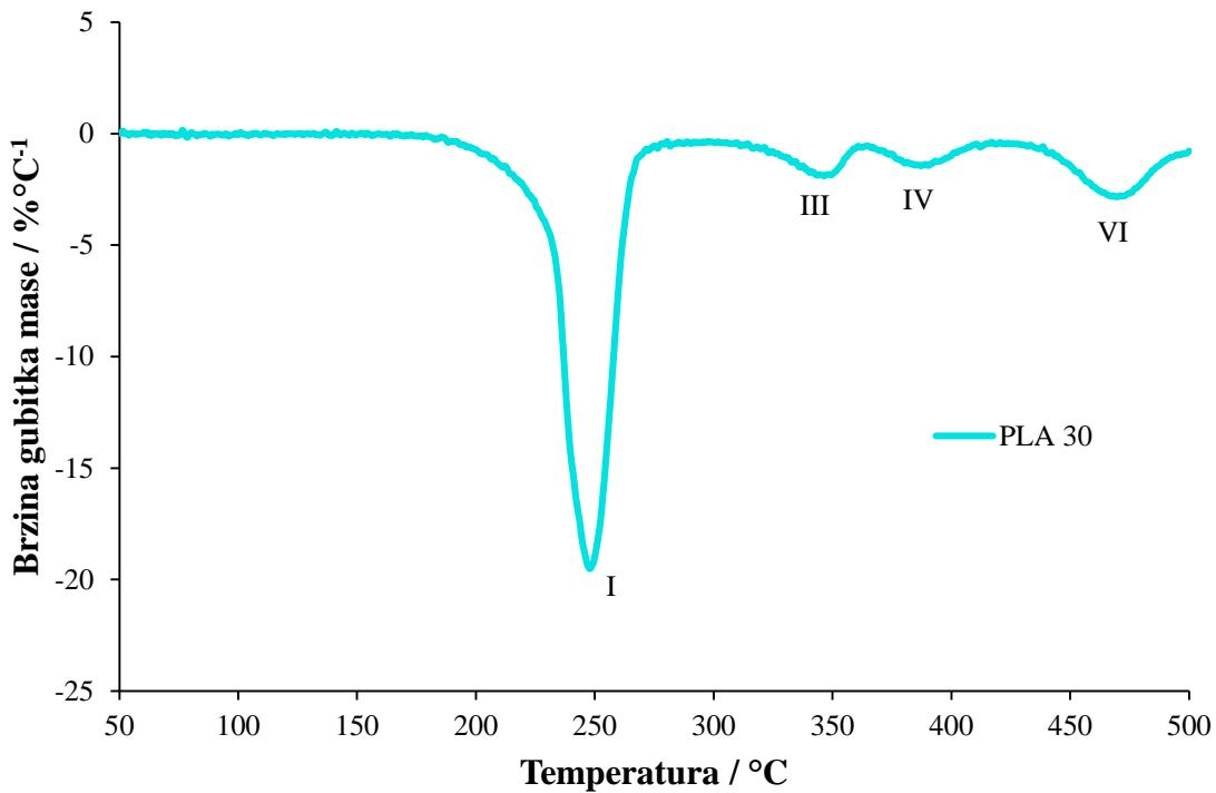
**Slika 31.** DTG krivulja neizotermne toplinske razgradnje PLA kompozita s 30%  $\text{Mg(OH)}_2$
