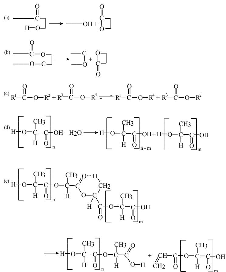
**Slika 4.** Prepostavljene reakcije razgradnje polilaktidne kiseline: (a) intramolekulna transesterifikacija (*backbiting*); (b) intramolekulna transesterifikacija; (c) intermolekulna transesterifikacija; (d) hidroliza; (e) pirolitička eliminacija<sup>14</sup>
