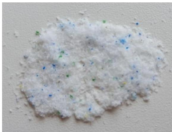
**Slika 7.** Samljevene granule polilaktidne kiseline s vidljivim nečistoćama
