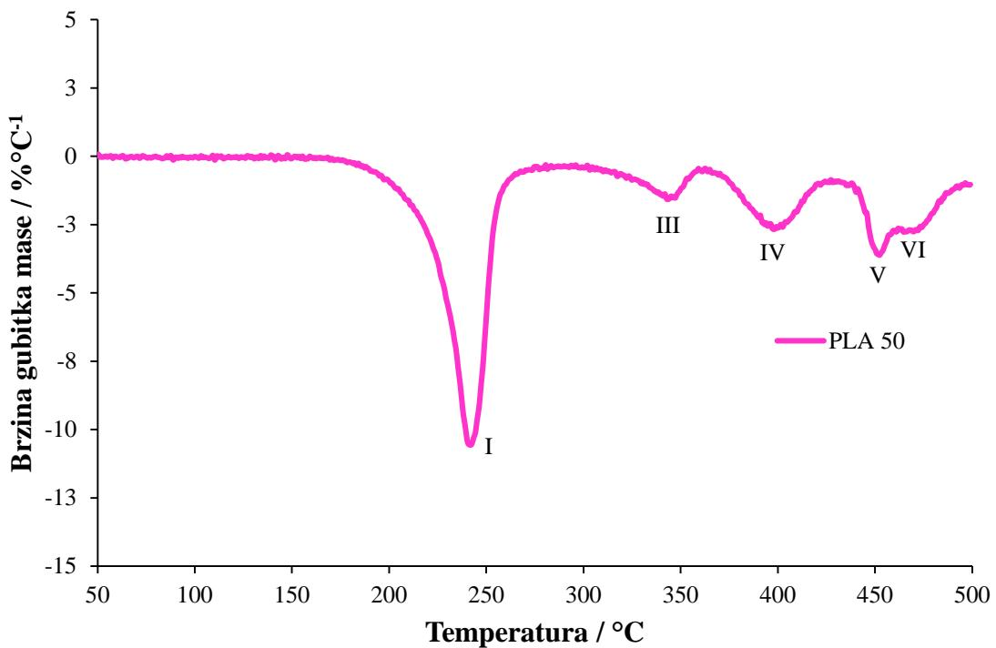
**Slika 33.** DTG krivulja neizotermne toplinske razgradnje PLA kompozita s 50%  $\text{Mg}(\text{OH})_2$
