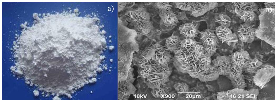
**Slika 6.** Magnezijev hidroksid: a) bijeli prah<sup>20</sup>, b) snimka kristala s pretražnim elektronskim mikroskopom<sup>21</sup>
