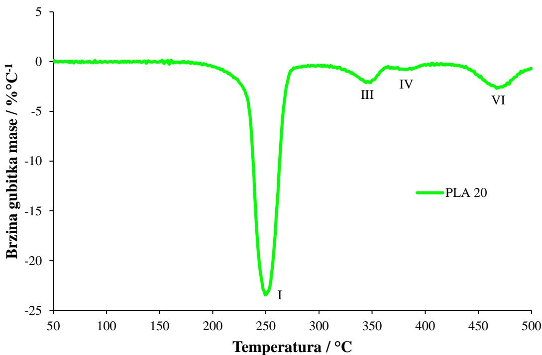
**Slika 30.** DTG krivulja neizotermne toplinske razgradnje PLA kompozita s 20%  $\text{Mg(OH)}_2$
