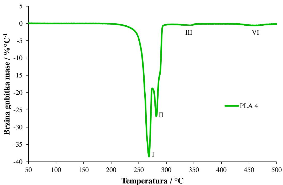
**Slika 26.** DTG krivulja neizotermne toplinske razgradnje PLA kompozita s 4%  $\text{Mg(OH)}_2$
