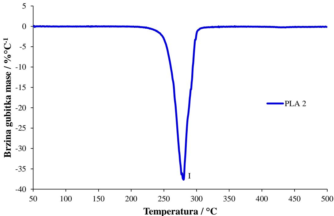
**Slika 25.** DTG krivulja neizotermne toplinske razgradnje PLA kompozita s 2%  $\text{Mg(OH)}_2$
