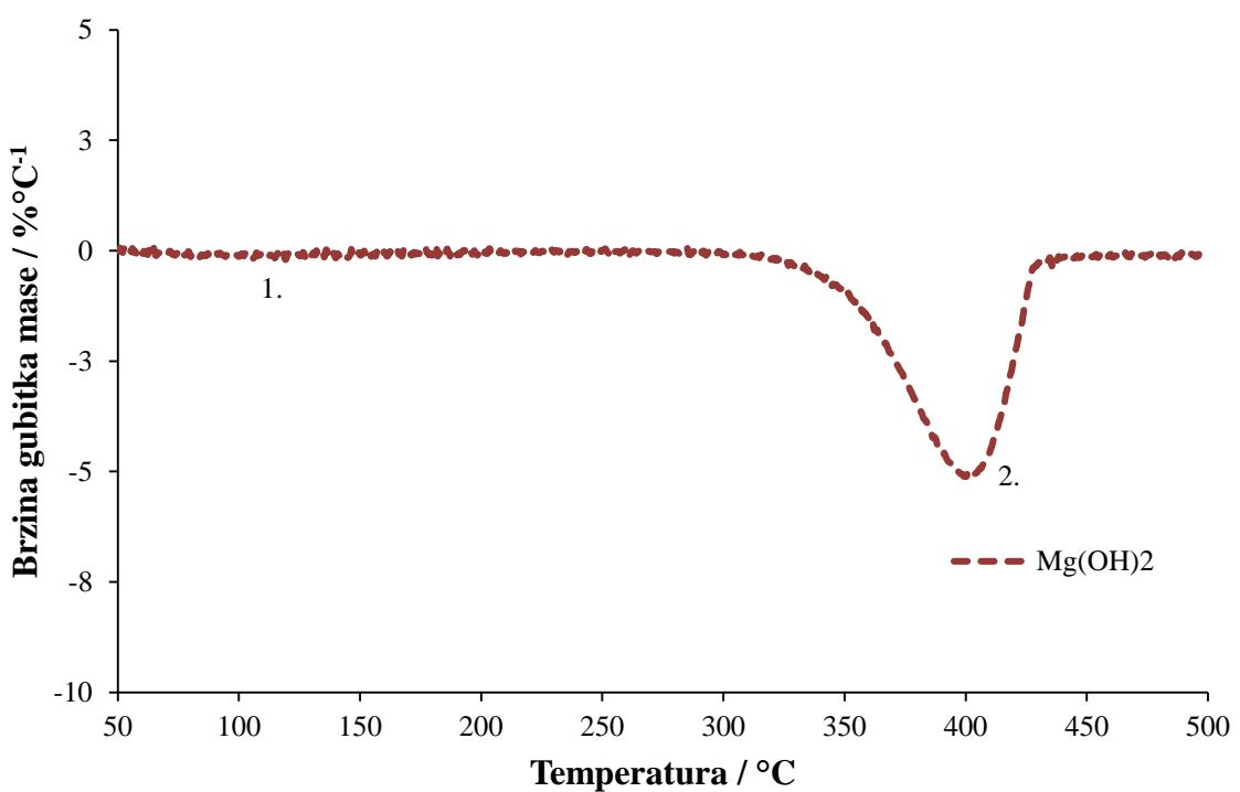
Slika 24. DTG krivulja neizotermne toplinske razgradnje  $\text{Mg}(\text{OH})_2$
