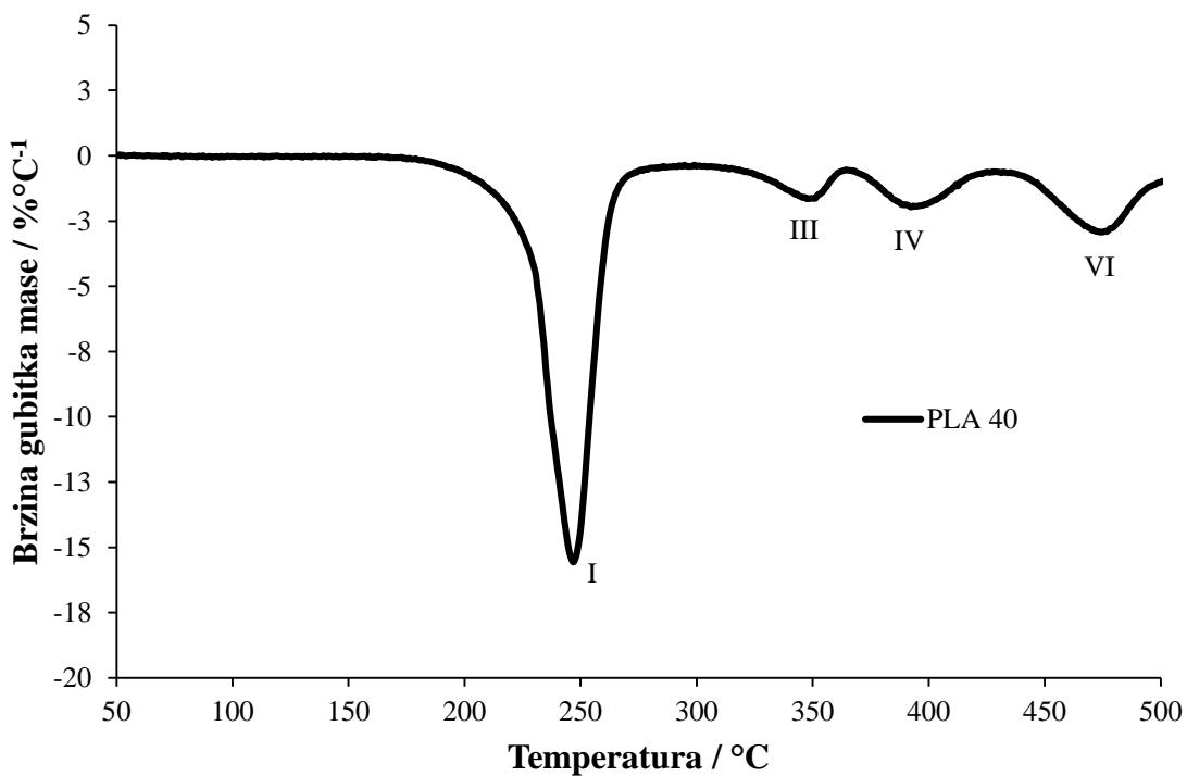
**Slika 32.** DTG krivulja neizotermne toplinske razgradnje PLA kompozita s 40%  $\text{Mg(OH)}_2$
