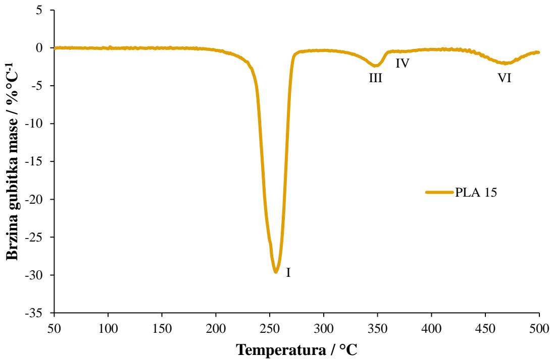
**Slika 29.** DTG krivulja neizotermne toplinske razgradnje PLA kompozita s 15%  $\text{Mg(OH)}_2$
