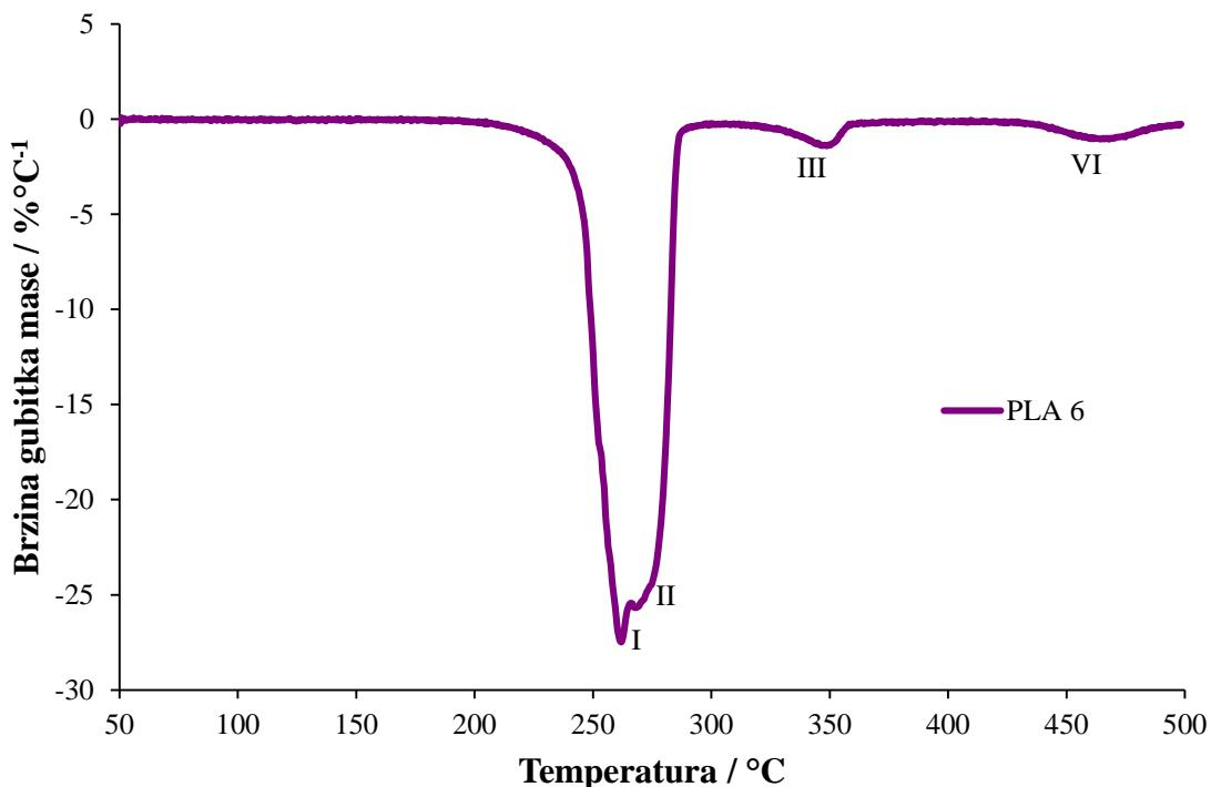
**Slika 27.** DTG krivulja neizotermne toplinske razgradnje PLA kompozita s 6%  $\text{Mg}(\text{OH})_2$
