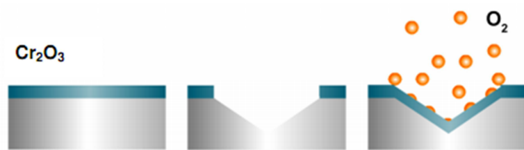
Slika 20. Prikaz mehanizma samo obnavljanja pasivnog filma kromovih oksida na površini. 36
