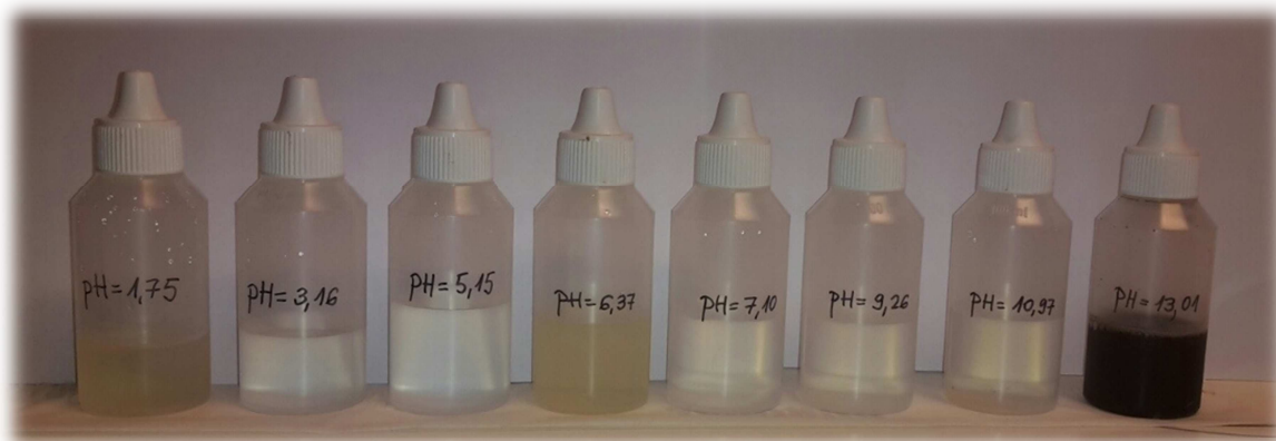
Slika 3.1. Eluati dobiveni nakon eksperimenta ispiranja tla u ultračistoj vodi različitih pH vrijednosti.
